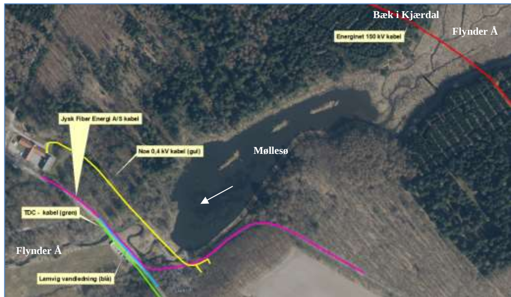
Oversigt der viser kabler og ledninger i området.
