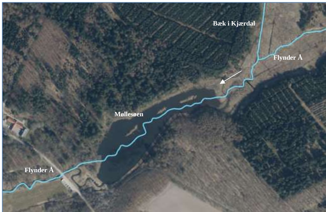
Løsning 1 skitse - fjernelse af opstemning og etablering af naturlig hydrologi i området. Ved denne løsning fjernes Møllesøen.
