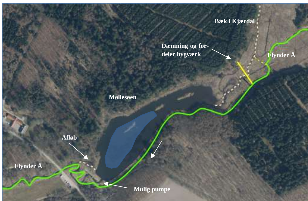
Løsning 2 og 3 skitseret - omløbsstryg uden om søen med/uden sænkning af det nuværende søvandspejl. Sænkning af søvandspejl, placering af pumpe, dæmning/spuns og
